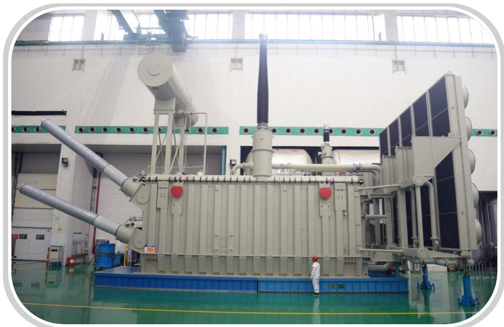
ZZDFPZ-509.4MVA/ 500-200kV换流变压器，用于国家重点工程扎鲁特至青州±800kV特高压直流输变电工程换流变压器（扎鲁特站）
