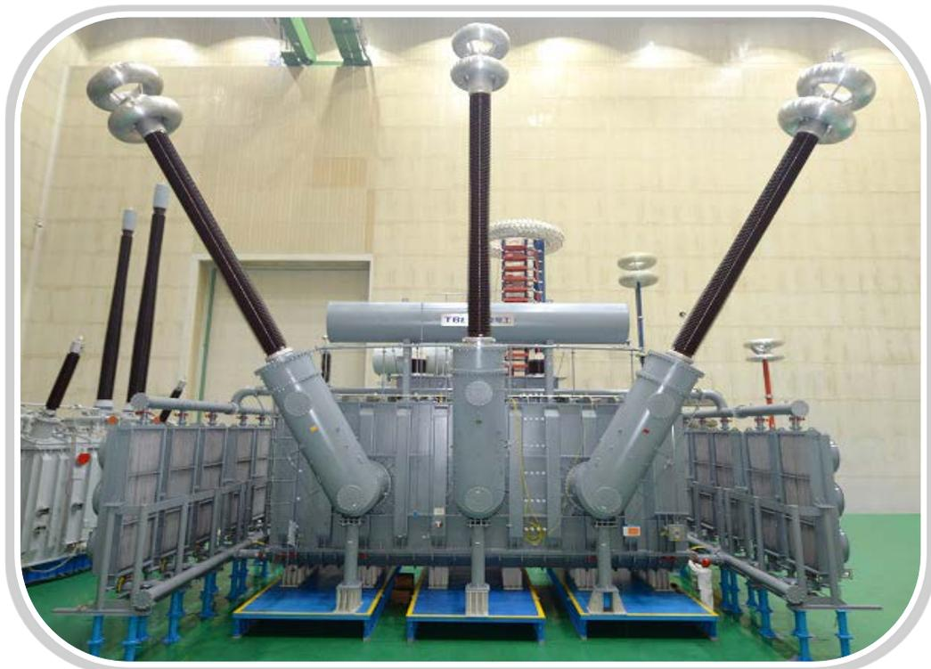
750kV级世界最大容量的SFP-JT-1230MVA/750kV三相现场组装式变压器
