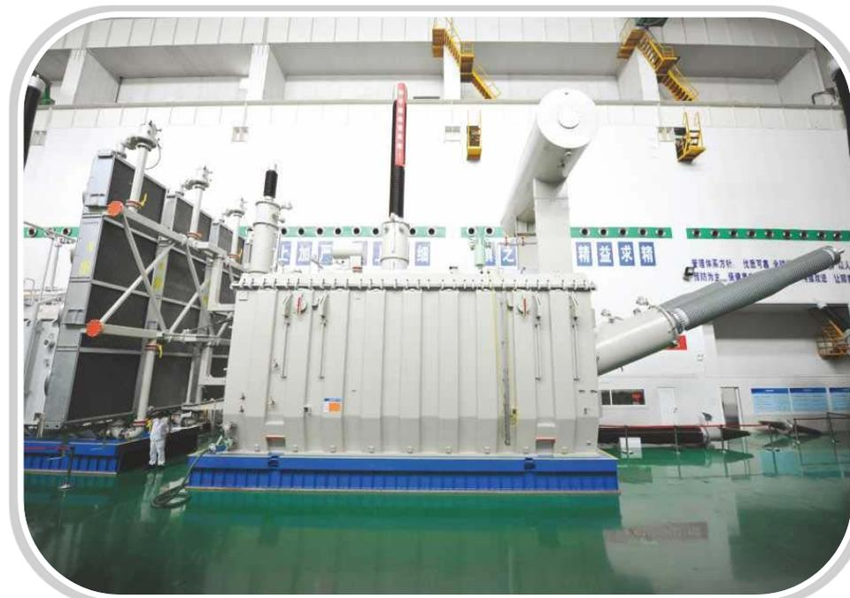
ZZDFPZ-289.7MVA/500-500kV (Y)换流变压器，
