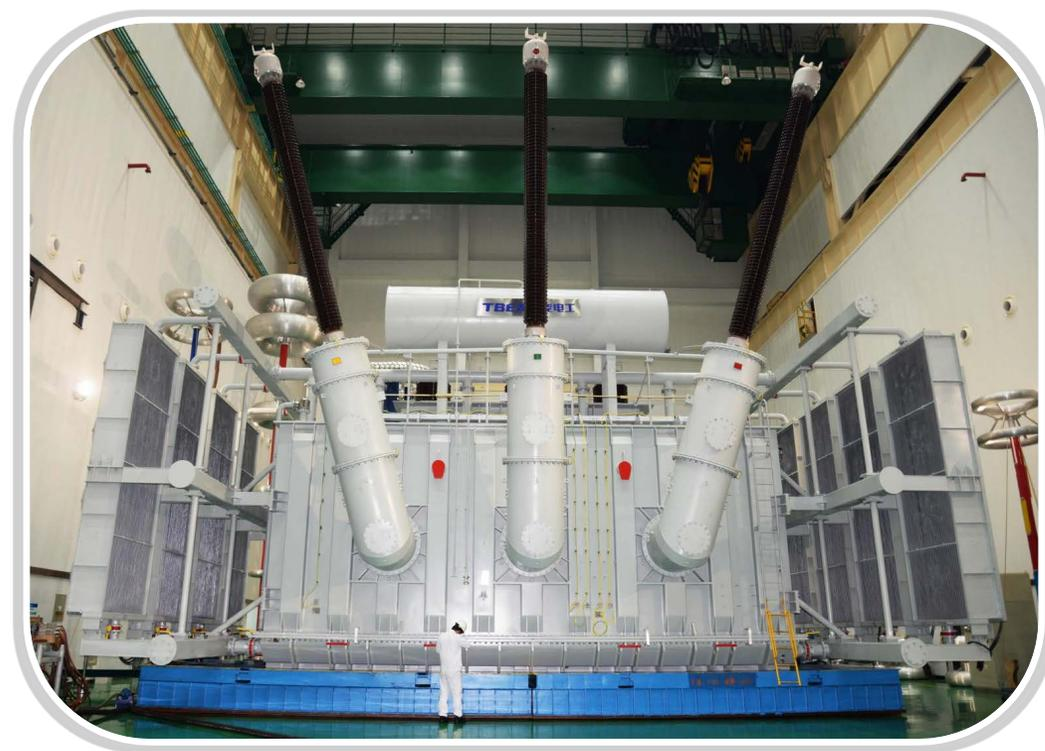
500kV级世界最大容量的SFP-JT-1180MVA/500kV三相现场组装式变压器
