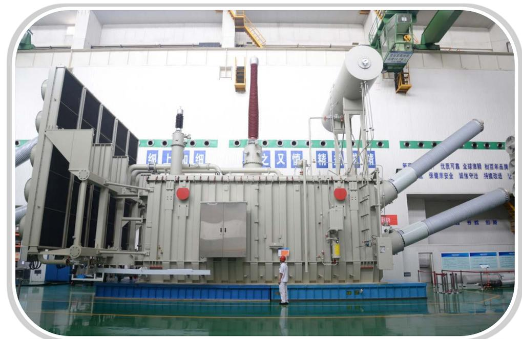
ZZDFPZ-509.4MVA/ 500-400kV换流变压器，用于国家重点工程扎鲁特至青州±800kV特高压直流输变电工程换流变压器（扎鲁特站）
